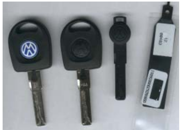
Original-, Zweit-, Ersatzschlüssel und Fähnchen (Plastikanhänger mit Schließungsnummer). Die unauffälligen Plastikschlüssel funktionieren genauso gut wie der Originalschlüssel.
